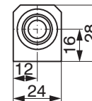
Abb. 4 Maßzeichnung ODC 1200, Messbereiche 2/5/10/16 mm, Abmessungen in mm, nicht maßstabsgetreu
