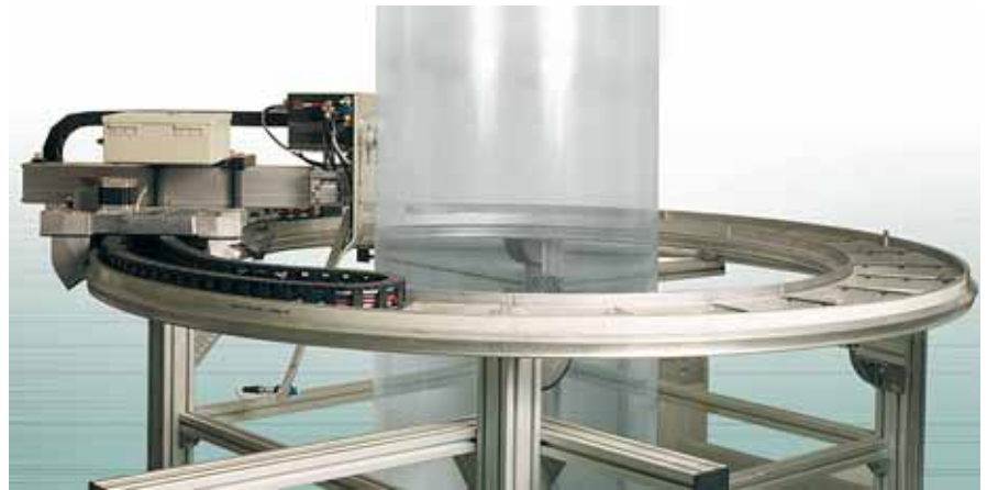
Pomiar grubości folii wydmuchiwanej w postaci rekawa
