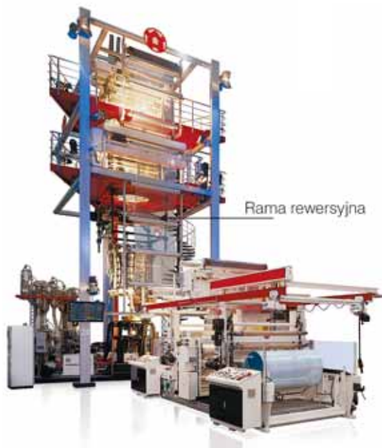
Rama rewersyjna zamocowana jest pomiędzy jednostką ekstrudera i mierzy grubość wypływającej folii
