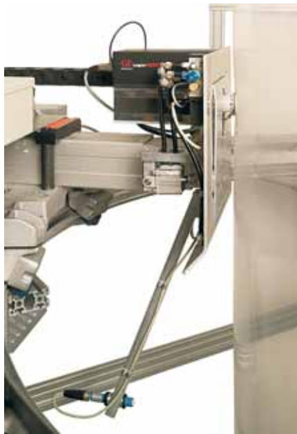
Czujnik pojemnościowy mierzy względem worka foliowego, dalej poniżej umocowano czujnik ultradźwiękowy.
